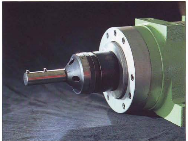
设备主轴上安装好补偿头和镗刀的状态
