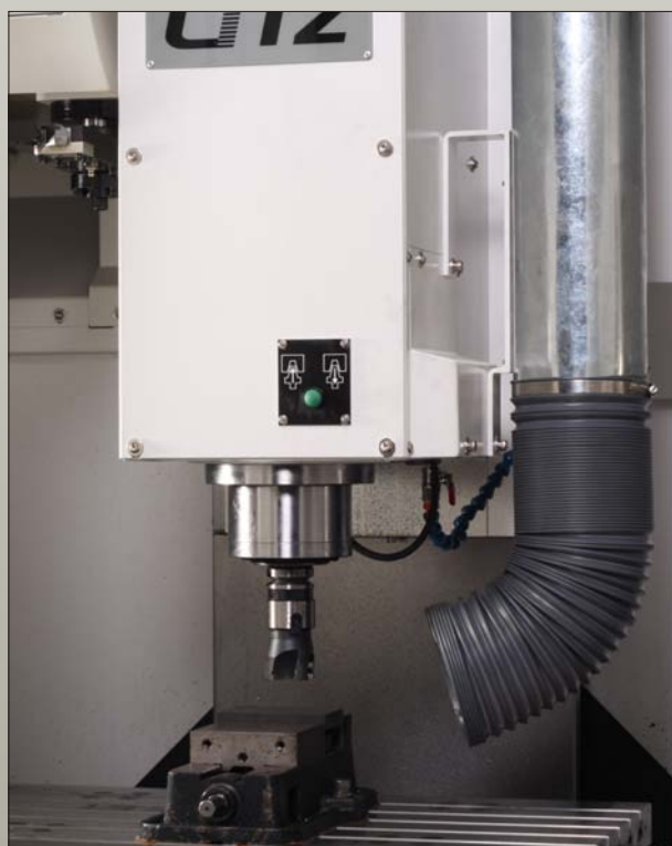
吸塵進口處緊鄰刀具，能發揮最大的吸塵效果
