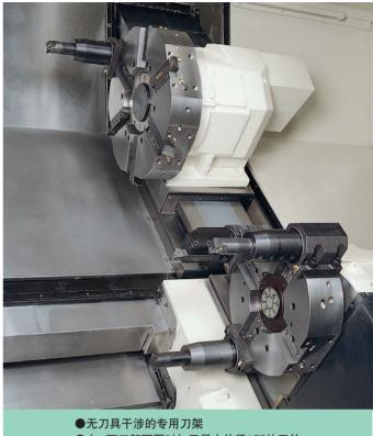
●上、下刀架可同时加工最大外径17"的工件
